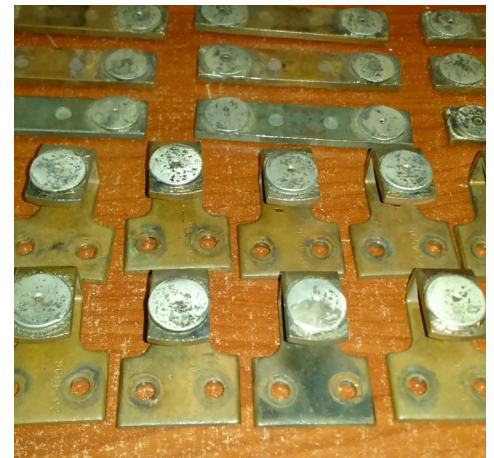
REPARACION DE CONTACTOS
